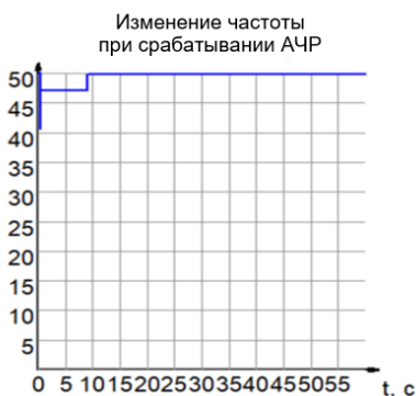
Рис.4. График изменения частоты при срабатывании АЧР-1 и АЧР-2
